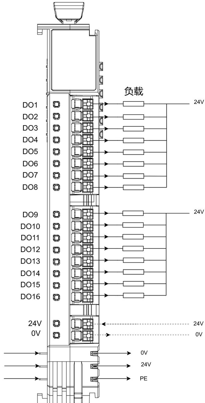
图 3.1 ZDM-E0016N 模块接线图
