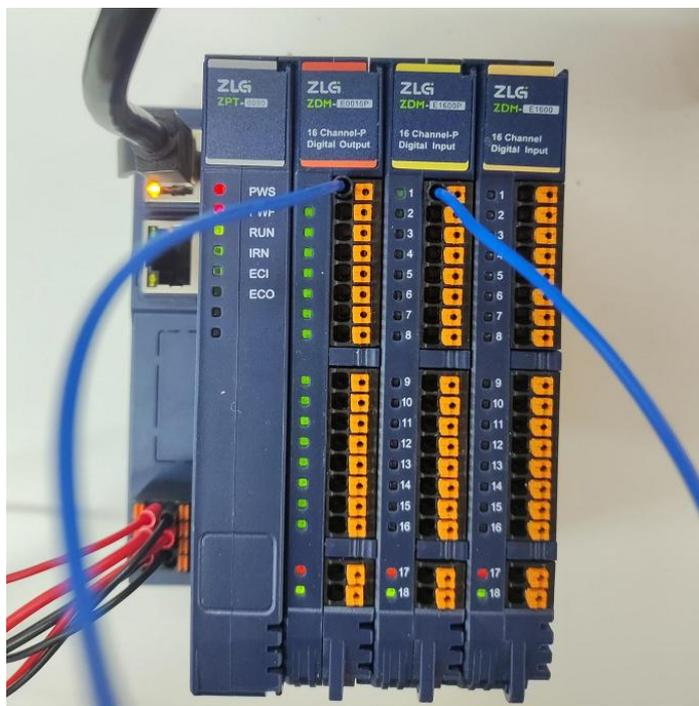
图 5.16 通道 1 接 PNP 型输入
